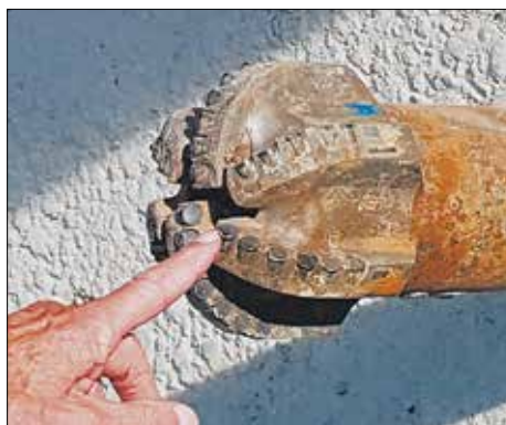
NAHAUFNAHME. Dieser Bohrer frass sich 200 Meter in den Kreuzlinger Untergrund.
